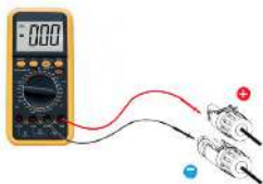
Rysunek 5.17 Pomiar z użyciem miernika uniwersalnego
